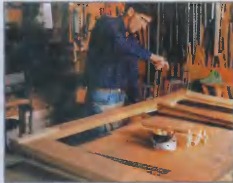
Стойки и все перемычки склеиваю
