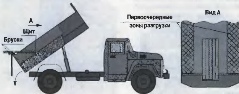
Рис. 2. Разгрузка раствора с помощью технологического щита
