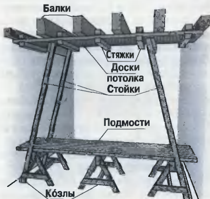
Рис. 12. Подшивка потолка щитами
