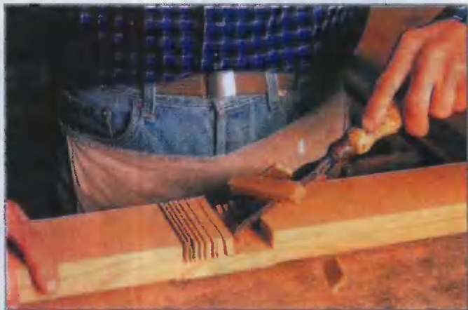
Изготовление гнезда соединения стойки и средника начинаю с серии поперечных пропилов
