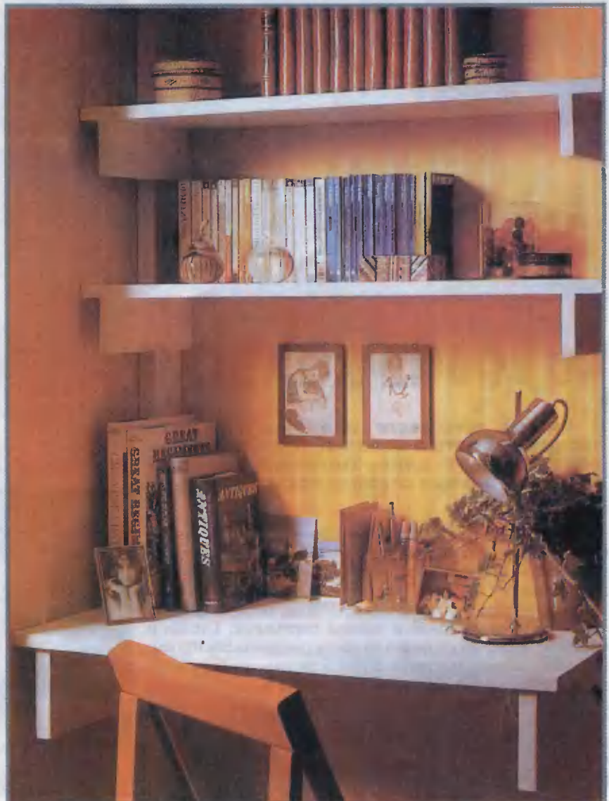
Книжная полка с небольшим письменным столом. Стойки могут быть прикреплены к стене или расклинены между полом и потолком
